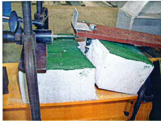
写真4.2 せん断試験体破壊状況/A3-1/ P_{max}=2767N
