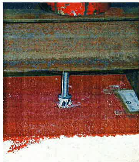
写真4.4 引張試験体破壊状況 B5-2/ P_{max}=887N
