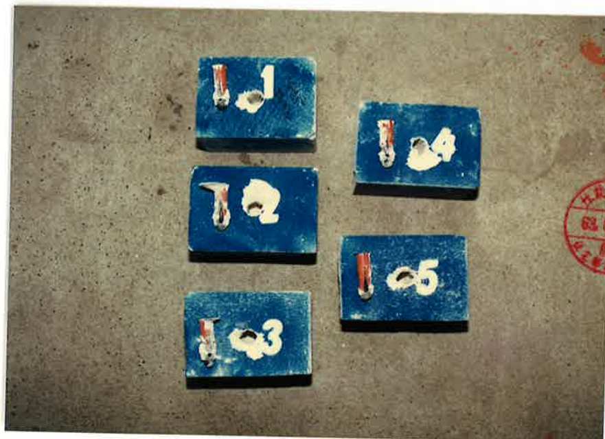
写真-2 破壊状況 (B-1545 接着剤使用)
