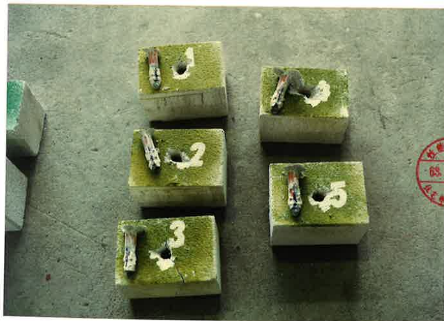
写真-4 破壊状況 (B-1560 接着剤使用)
